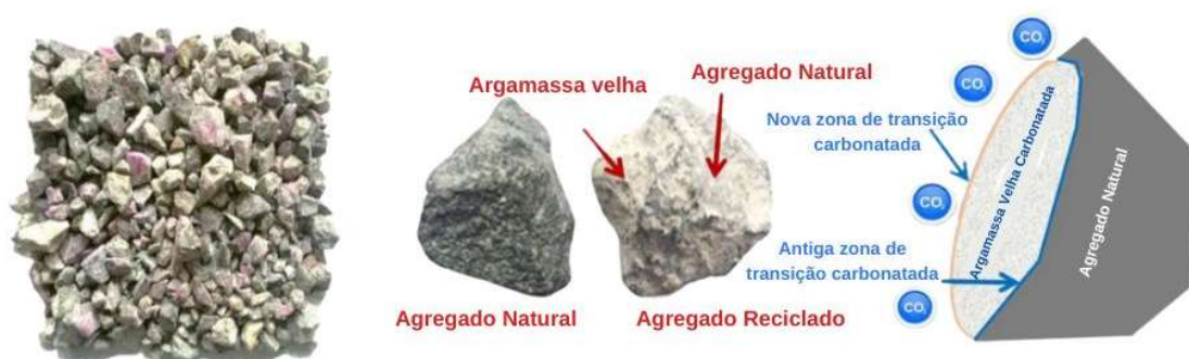
Figura 3 – Fortalecimento da zona de transição pós carbonatação do AR. (Zhang et al. 2015).
