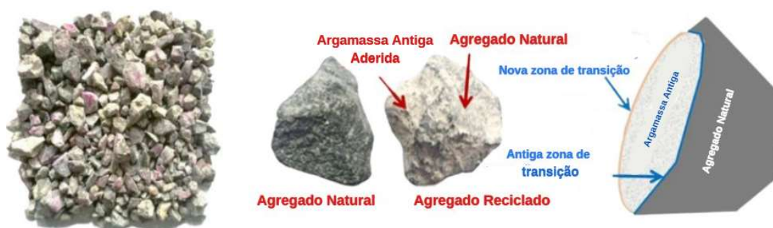
Figura 1: Exemplo de ACR e as zonas de transição. (Zhang et al. 2015).
